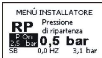
Figure 16: Configuration de la pression de redémarrage
